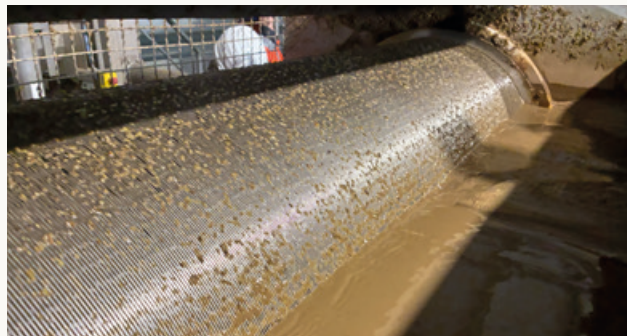
Alles, was zurück auf den Acker kommt, muss in der Zuckerfabrik von Pfeifer & Langen in Lage durch ein 0,5 mm großes Sieb. Bild: Günter Klingenhagen
